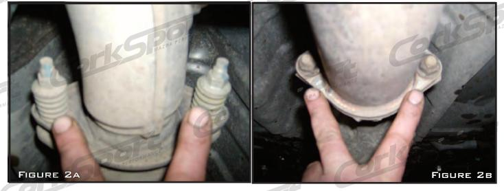
A) REMOVE THE TWO 14MM NUTS HOLDING THE FWD SECTION OF THE FACTORY CATALYST PIPE TO THE DOWNPIPE. THE STUDS MAY COME OUT, IF SO, DON'T WORRY ABOUT IT. RETAIN THE TWO SPRINGS FROM THE FACTORY FASTENERS.
